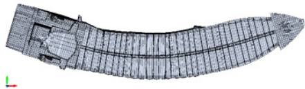
Fig. 9 FE model- Hyd. & cargo, Global horizontal mode 1: 1.59 Hz
