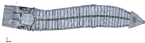
Fig. 10 FE model- Hyd. & cargo, Global horizontal mode 2: 3.12 Hz
