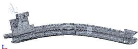
Fig. 7 FE model- Hyd. & cargo, Global vertical mode 1: 1.04 Hz
