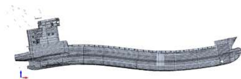
Fig. 8 FE model- Hyd. & cargo, Global vertical mode 2: 2.32 Hz
