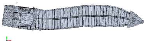
Fig. 10 FE model- Hyd. & cargo, Global horizontal mode 2: 3.12 Hz
