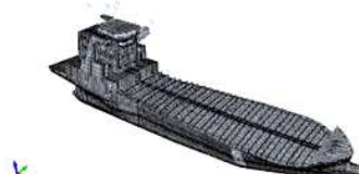
Fig. 12 FE model- Hyd. & cargo, Global torsion mode 1: 2.12 Hz
