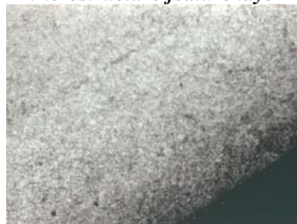
Layer hardness: 713 HV, 739 HV, 745 HV
