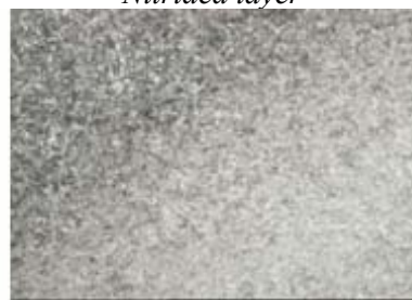
Middle layer hardness: 412 HV, 516 HV, 549 HV
